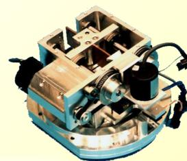
関節に機械的な柔軟性を持たせた機構です。受動的に関節の柔らかさやばねの平衡点を変更できるので、人間との協調作業が可能です。
