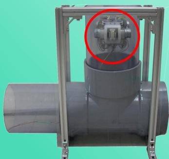
配管内を自在に移動できるロボットです。姿勢制御により2点接触構造で安定した姿勢を保ちながら移動します。
