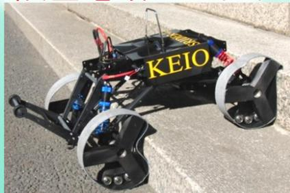
回転入力のみで段差踏破が可能な非円形車輪“TFW(Transformable Flexible Wheel)”を用いた低コストなロボットです。車輪半径の1.8倍もある段差を上ることができます。
