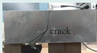
・ 内部き裂を模擬した実験試料
